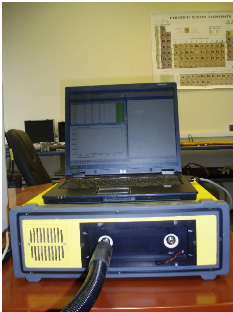
Slika 5. FT/IR analizator u konfiguraciji za analize na radnom pri uvjetima instrumenta (50°C) kao u ovom slučaju
